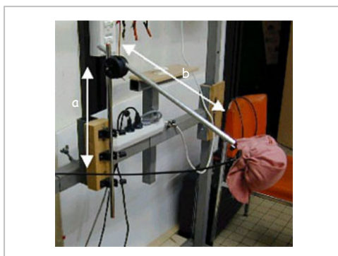
Figure 32 : Capteur de force, enveloppé dans un capuchon de mousse, la flèche "a" indique le réglage vertical et la flèche "b" indique l'avancée et l'inclinaison du capteur.
